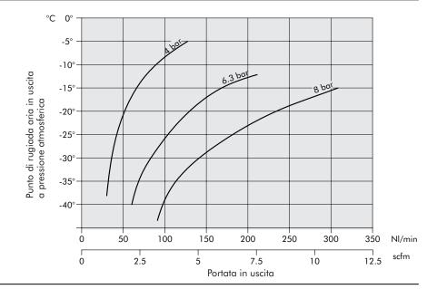
Nei grafici sotto viene indicato il punto di rugiada dell'aria compressa in uscita, per diversi punti di rugiada dell'aria in ingresso, in funzione della portata.
