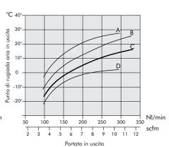
A : aria in ingresso con punto di rugiada a 45°C B : aria in ingresso con punto di rugiada a 35°C C: aria in ingresso con punto di rugiada a 25°C D: aria in ingresso con punto di rugiada a 15°C
